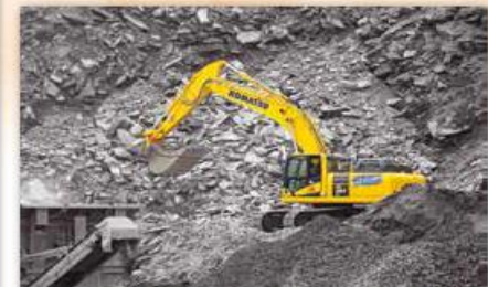
Komatsu Bagger HB365LC-3 mit Hybridantrieb, 36 to Betriebsgewicht
