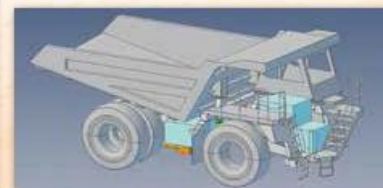
Komatsu-Hybridsystem: 1 – Kondensator, 2 – Umrichter, 3 – elektrischer Schwenkmotor/Schwenkgenerator, 4 – Verbrennungsmotor, 5 – Generator/Motor, 6 – Hauptpumpe
