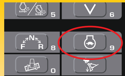
Wenn sich die Bedienhebel für eine vordefinierte Zeit in Neutralstellung befinden, reduziert die neue Drehzahlabsenkung automatisch die Motordrehzahl.
