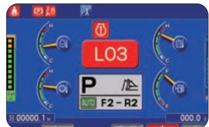
Monitorsystem mit Selbstdiagnosefunktion
