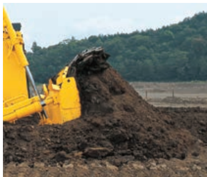
Der Sigmaschilder®-Schild bietet maximales Volumen und minimalen Materialverlust
