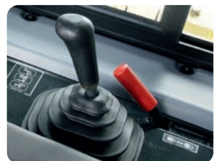
Besser erreichbare Sicherheitshebel
