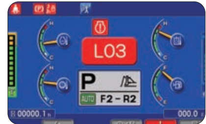
Monitorsystem mit Selbstdiagnosefunktion
