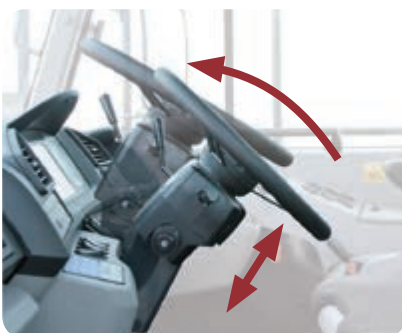
Das Lenkrad lässt sich für jeden Fahrer in die optimale Position bringen.
