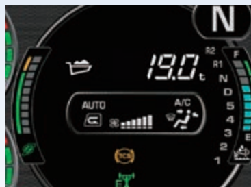
Die Zuladung ist auf der Anzeige der Nutzlastwaage ablesbar
