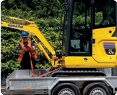
Verzurrösen am Oberwagen ermöglichen eine schnelle Transportsicherung
