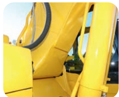
Gegossener Auslegerfuß und einteilige Platten am Ausleger
