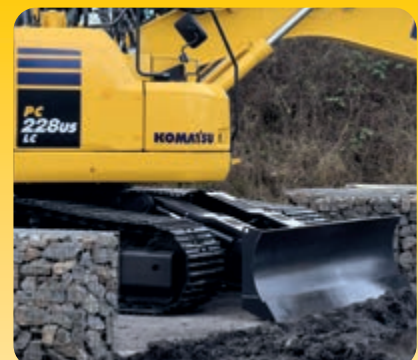
Planierschild (optional), geeignet für 600 mm Dreistegbodenplatten (Stahl) und Roadliner-Bodenplatten (Gummi)
