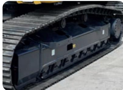
Laufrollenschutz über die gesamte Laufwerkslänge (Option)
