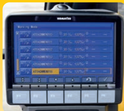
Komatsu Integrated Attachment Control (KIAC) mit bis zu 15 Voreinstellungsmöglichkeiten für Ölstrom und -druck (optional)
