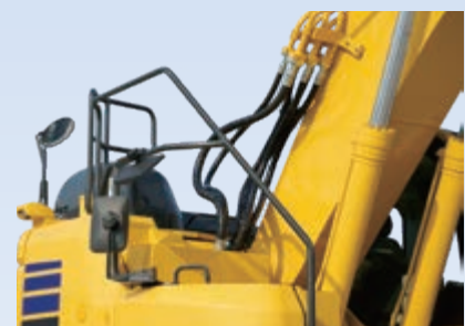
Handläufe und rutschfeste Oberflächen
