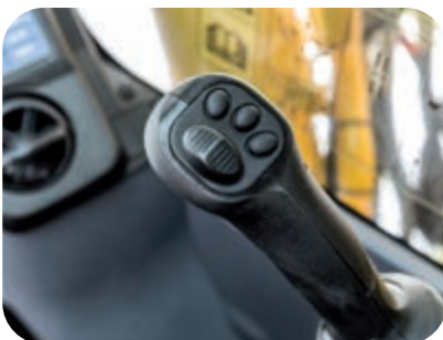
Komfortable, ergonomische und präzise Steuerung: Joysticks mit Proportionalastern für die Anbaugerätesteuerung
