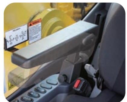
Armstütze mit einfacher Höhenverstellung
