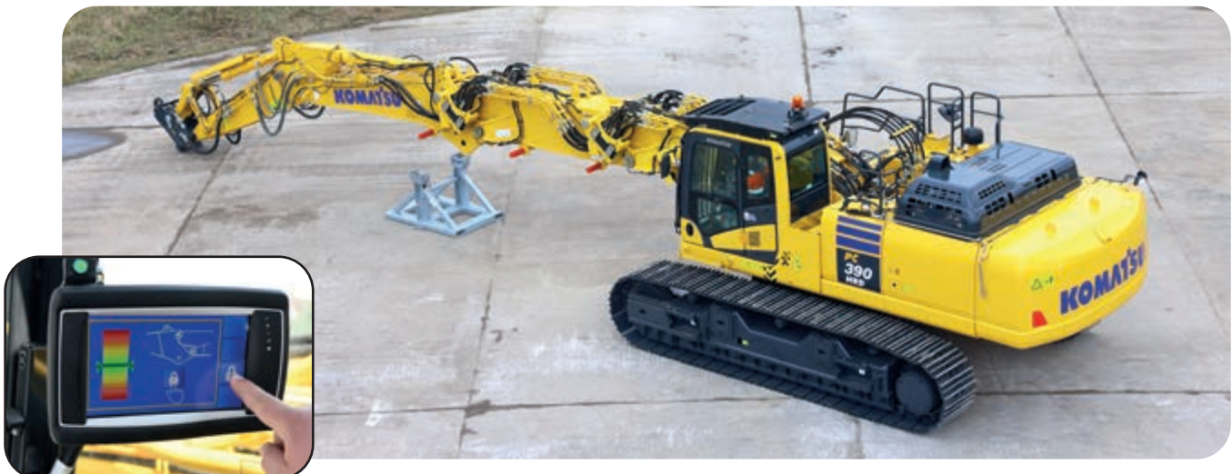
K100-Ausleger-Wechselsystem (optional) Auslegerverbindung ohne manuelle Arbeitsschritte mit moderner Mensch-Maschine-Schnittstelle für mehr Sicherheit. Niedrige Ablage-/Transportstützen inklusive.
