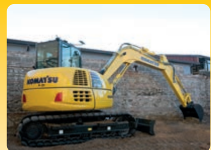
Kinderleichtes Grabenziehen dank reduziertem Frontschwenkradius und Auslegerschwenkfunktion
