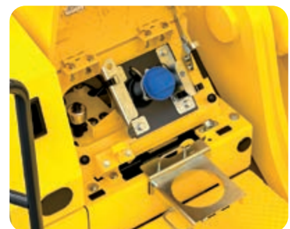
Der AdBlue®-Tank ist in der vorderen Treppe installiert. Die integrierte Arbeitsfläche vereinfacht das Nachfüllen von AdBlue®.
