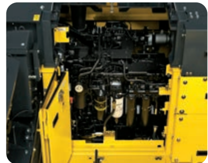
Zentral angeordnete Filter
