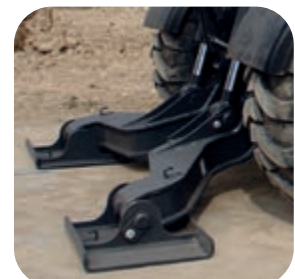
Schild-/Pratzenzylinder mit integriertem Rückschlagventil (Standard)
