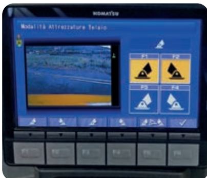
Einfachste Steuerung der Unterwagenabstützungen
