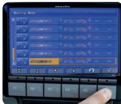
Komatsu Integrated Attachment Control (KIAC) mit bis zu 15 Voreinstellungsmöglichkeiten für Ölstrom und -druck (optional)
