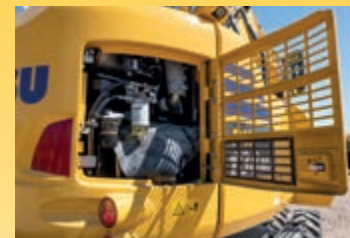
Alle wichtigen Wartungspunkte sind bequem vom Boden aus erreichbar
