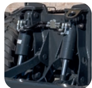
Schild-/Pratzenzylinder mit integriertem Rückschlagventil (Standard)
