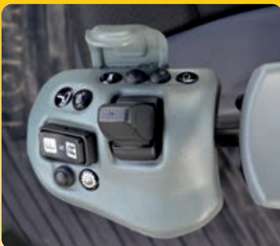
Komatsu Kurzhebel-Lenkssystem (K-SLS) (optional)
