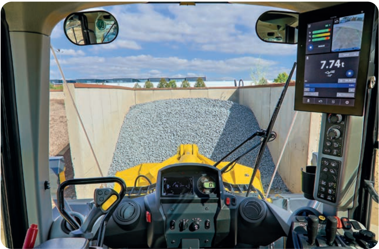
Abbildung zeigt Joystick-Lenssystem (AJSS) und SubMonitor (Sonderausrüstungen)
