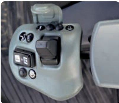
Komatsu Kurzhebel-Lenksystem (K-SLS) (Option)
