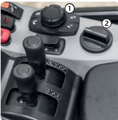
Komatsu Kurzhebel-Lenksystem (K-SLS) (Option)
