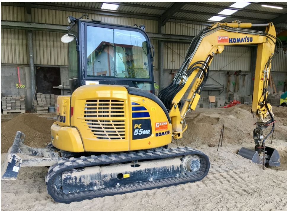
Bild 2: Die Maschinen, die in Geradstetten zur Ausbildung eingesetzt werden, entsprechen einem Querschnitt der Baumaschinen, die auf Baustellen im Einsatz sind. So auch der neue Komatsu PC55MR, der hinsichtlich Leistung und Wendigkeit gerne im Straßenbau eingesetzt wird.
