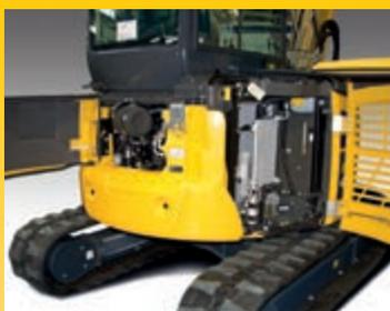
Hintere Wartungsklappen für schnelle Motorinspektion und Betankung, einfachen Wartungszugang, leichte Reinigung der Kühler und guten Zugang zur Batterie
