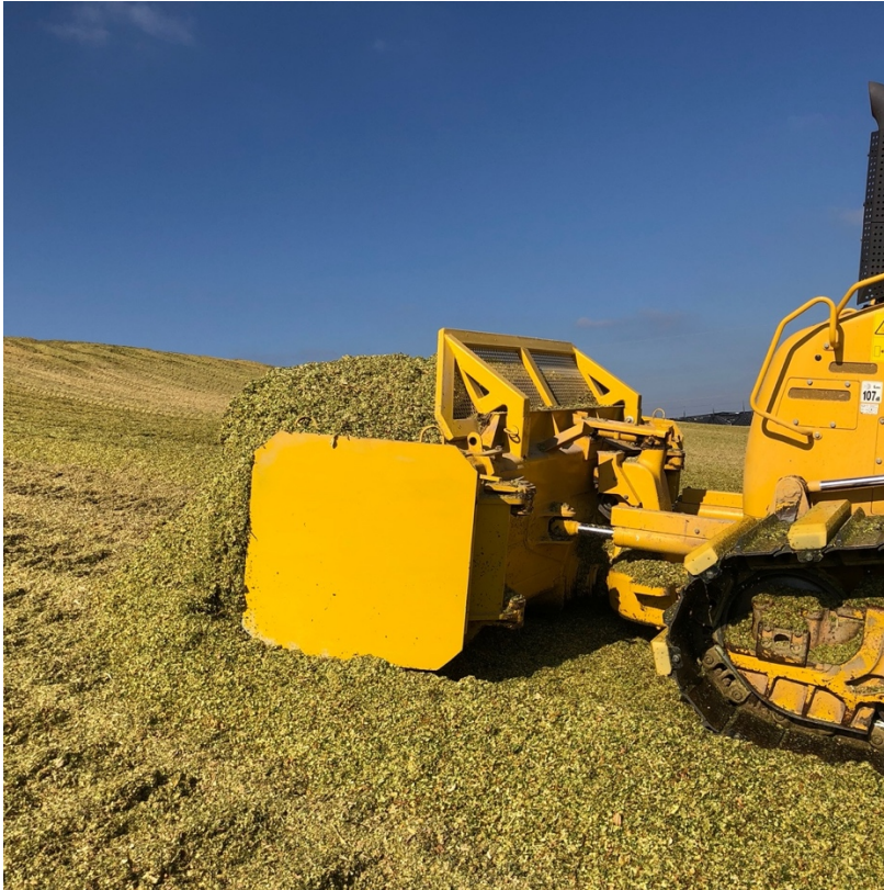
Bild 3: Die i-Technologie von Komatsu hilft unter anderem dabei, das ideale Gefälle der Oberfläche zu erreichen und den Wasserablauf in die richtige Richtung zu steuern.
