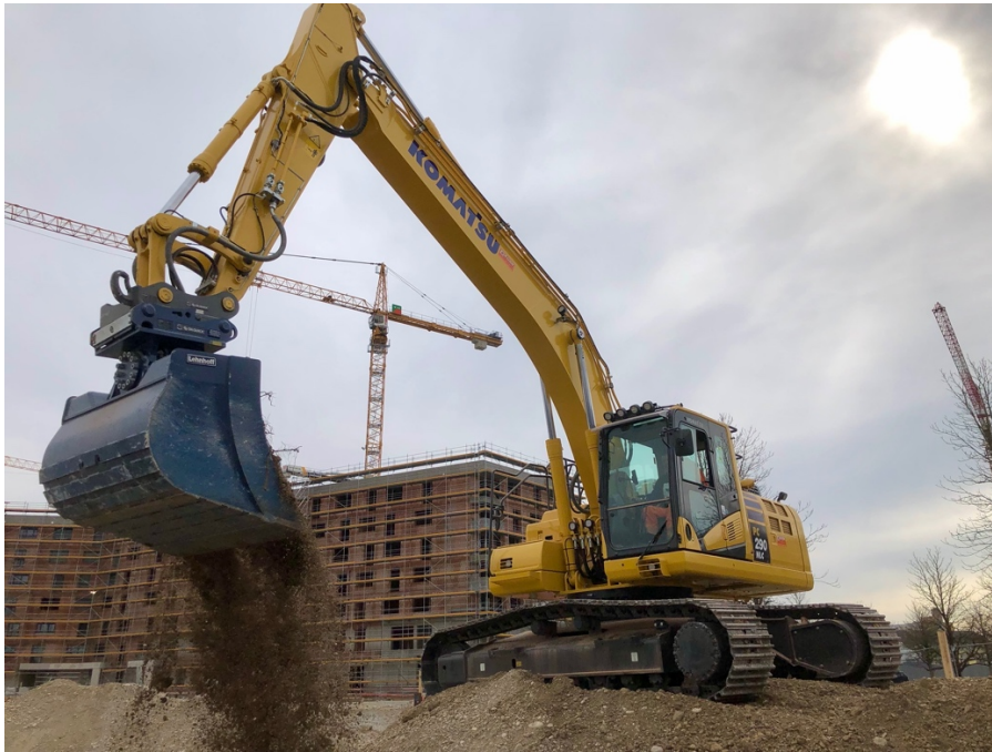
Bild 2: Der PC290 ist mit Oil-Quick ausgestattet, um schnelle und unkomplizierte Arbeiten mit verschiedenen Anbauteilen sicherzustellen.
