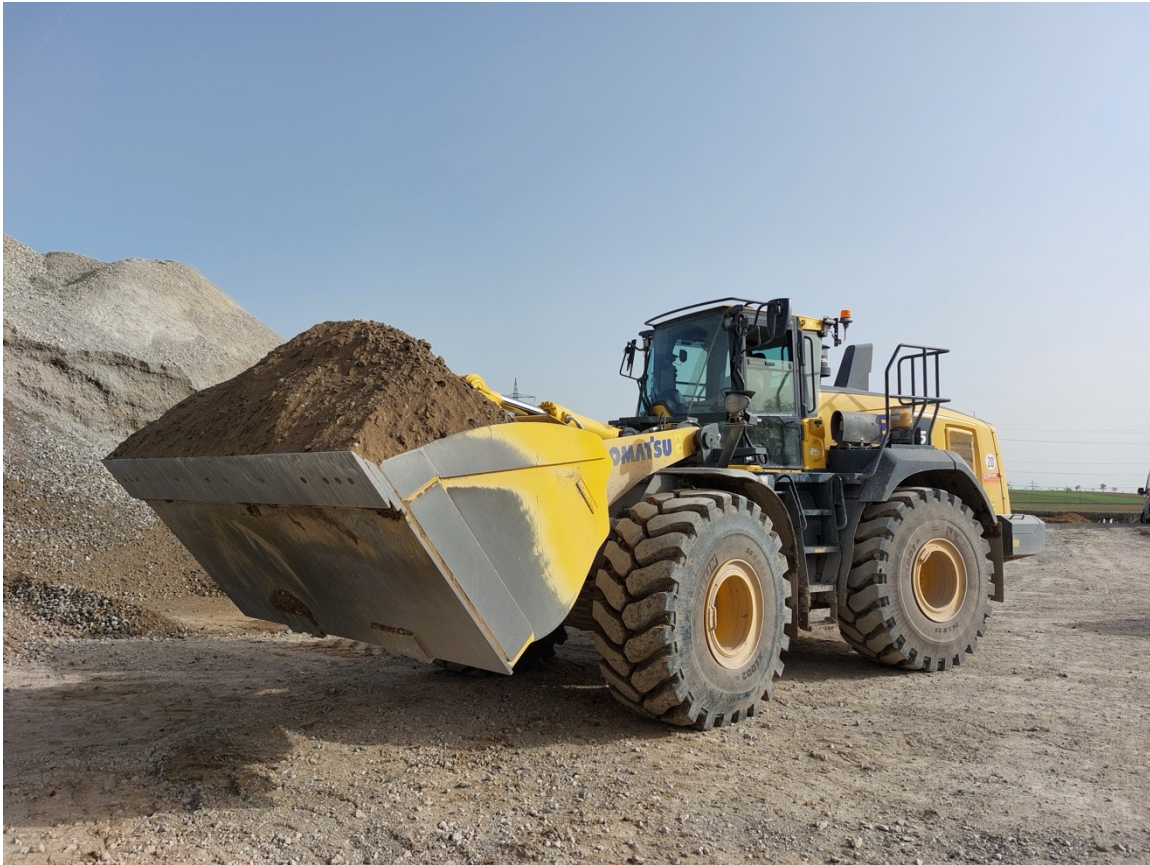
Bild 2: Zur Rückverladung, für Planierarbeiten und bei Bedarf in der Deponie wird der neue Radlader der Schotterwerke Markgröningen verwendet.
