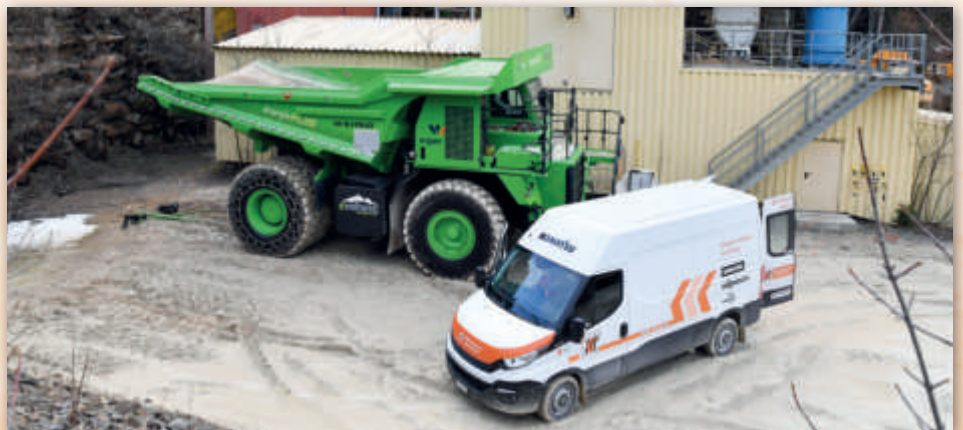
Im Auftrag des Zementherstellers Ciments Vigier SA für den weltweit ersten batteriebetriebenen eDumper wurde in den vergangenen zwei Jahren das Komatsu Gerät auf Batterieantrieb umgerüstet.
