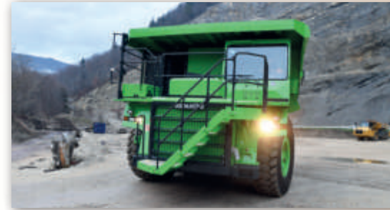
Eine weitere Besonderheit des eDumper ist die neukonstruierte Stahl-/Gummi-Kippmulde.
