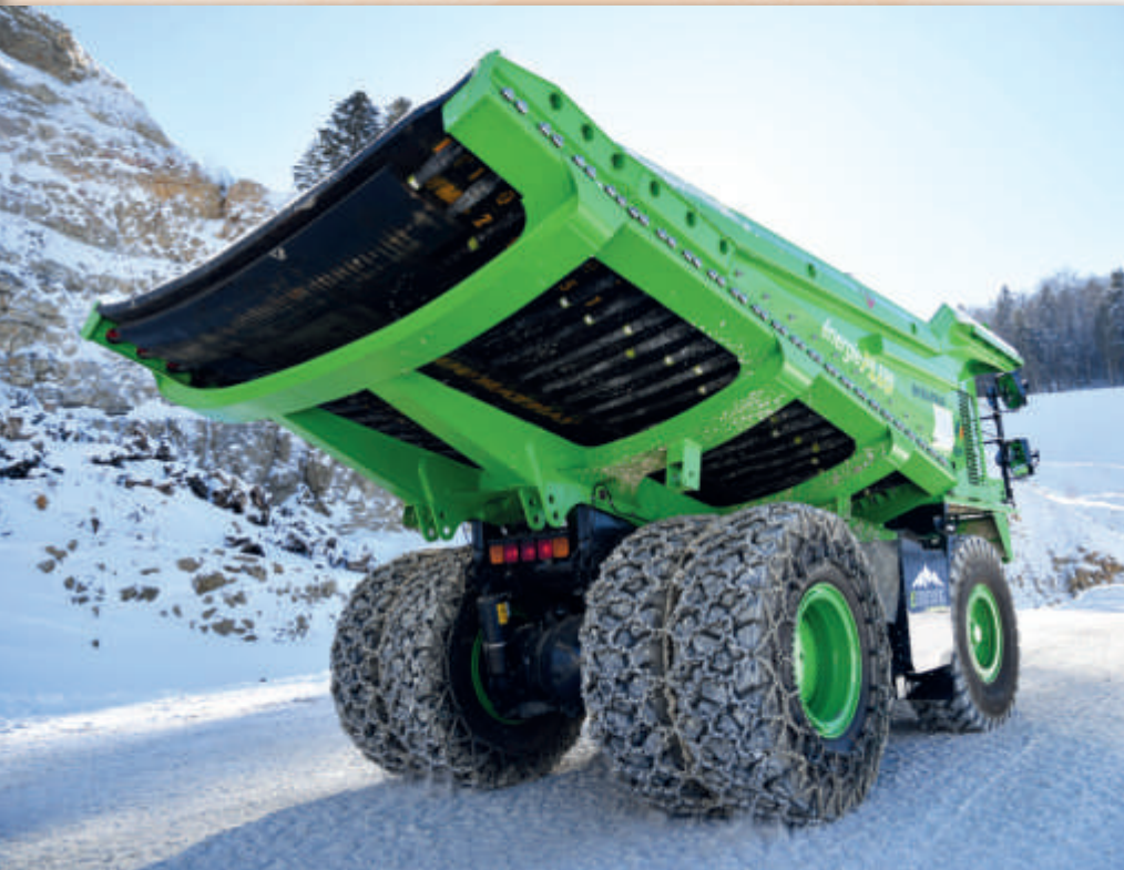
Der Muldenkipper rekuperiert Strom bei Talfahrt im Steinbruch. Diese zukunftsweisende Entwicklung wurde bereits mit einem Innovationspreis ausgezeichnet und präsentiert sich gleich mit drei Weltrekorden: größtes batteriegetriebenes Fahrzeug der Welt, größte mobile Batterie der Welt, größte CO 2 -Einsparung pro Fahrzeug.
