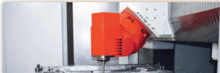
5-Achs-Simultan-Bearbeitung einer Spritzgußform
