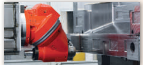
Leistungsstarker stufenloser mechanischer Universalkopf für die Schrupp- und Vorschlichtbearbeitung
