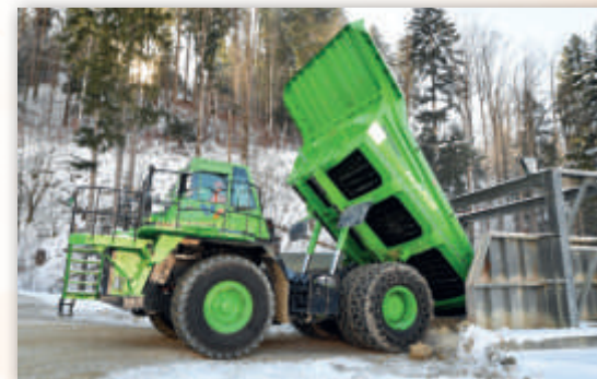
Der eMining Dumper Nummer 1 wird die nächsten 10 Jahre jährlich über 300.000 t Gestein transportieren. Er wird als Plus-Energie-Fahrzeug betrieben und erzeugt durch Rückgewinnung bei den Talfahrten gleichzeitig CO 2 freien Strom von 77 MWh/Jahr und erzielt eine CO 2 Einsparung von 130 t/Jahr.
