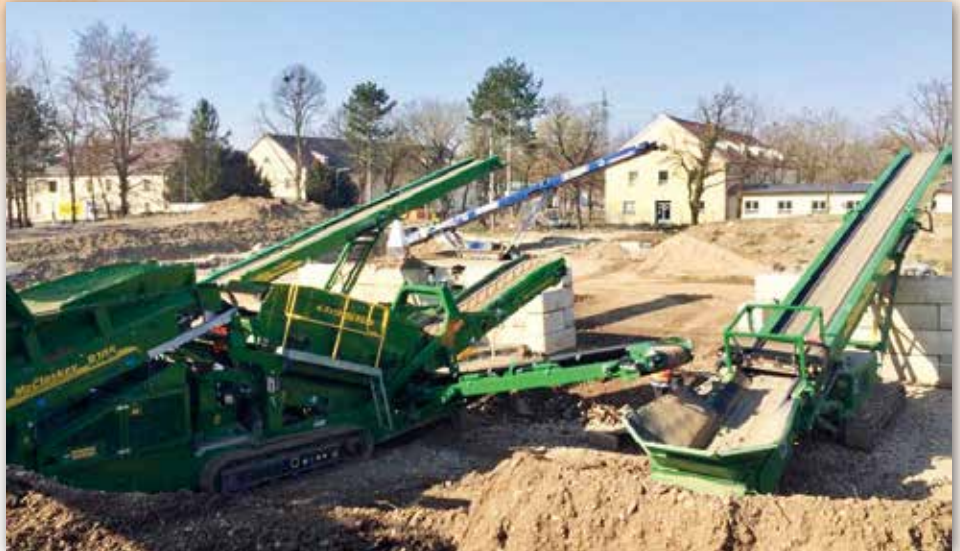
Bodenaustausch und -aufbereitung auf höchstem Niveau, das betreibt die KARL-Gruppe seit kurzem mit einer neuen Sieb-, Sortier- und Aufhalde-Lösung von McCloskey und Kuhn Baumaschinen Deutschland.
