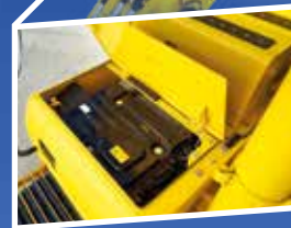
WECHSELRICHTER UND KONDENSATOR
