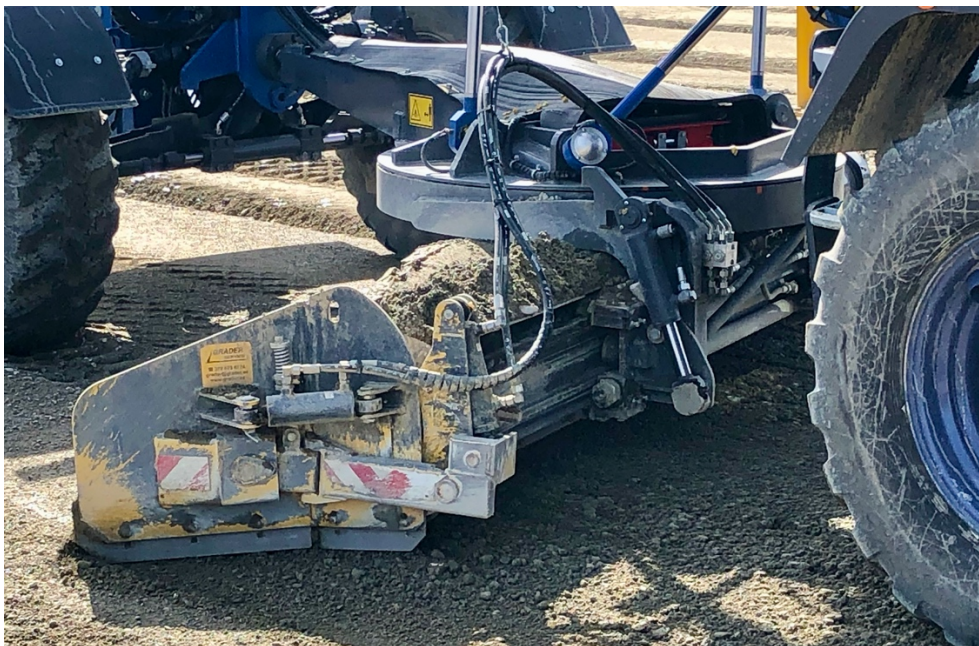
Bild 3: Das hydraulisch verstellbare Scharseitenblech, welches zum ersten Mal in dieser Bauart in Deutschland ausgeliefert wurde, sorgt für eine effektivere Scharfüllung und eine höhere Massenbewegung.
