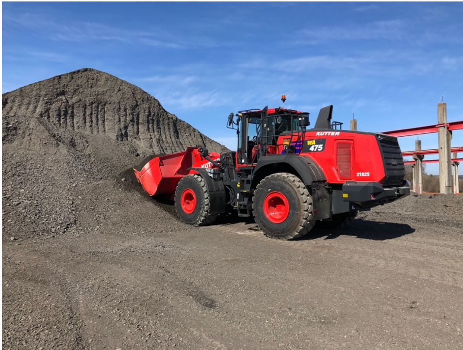
Bild 2: Auch zum Asphalt Fräsgut laden wird der Komatsu Radlader im Asphalt- und Betonmischwerk eingesetzt.
