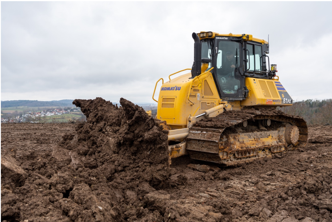
Bild 1: Optimale Sicht auf Schild und Laufwerk bietet die Komatsu Kettenraupe D61PX. So stellt Gronbach effektiven Einsatz in der Erdeponie sicher. Die Raupe ist etwa 1.000 Betriebsstunden im Jahr im Einsatz.
