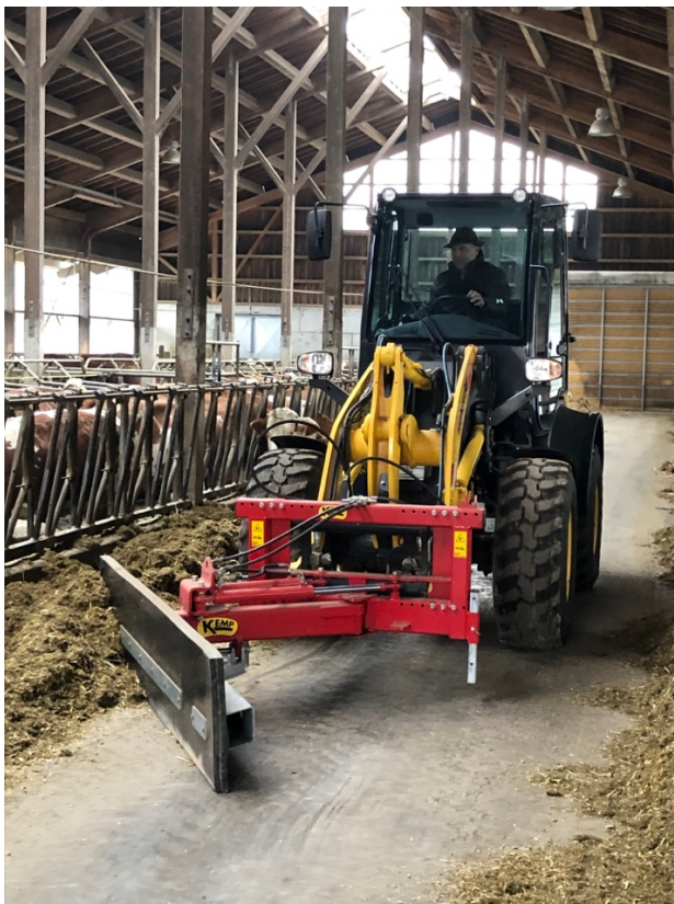
Bild 2: Der Radlader wird mit zahlreichen Anbauteilen verwendet, unter anderem mit dem Schubschild bei der Fütterung.
