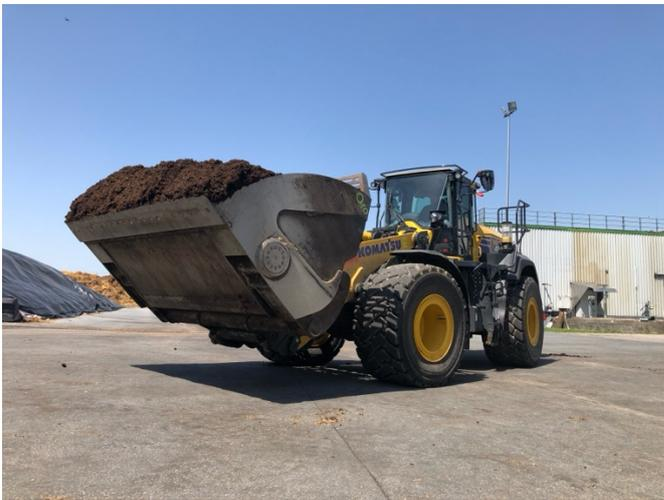
Bild 3: Die Maschine ist ausgestattet mit Breitreifen, geeichter Waage und Schnellwechsler.
