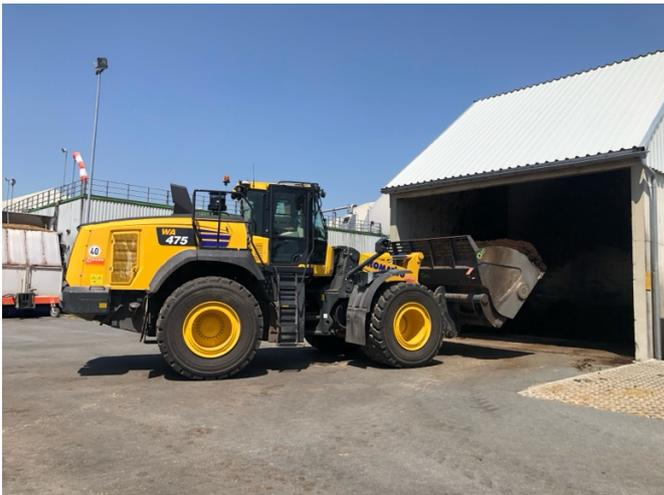
Bild 4: Der 25 Tonnen schwere Radlader ist mit einem Motor gemäß EU Stufe V sowie dem leistungsverzweigten Getriebe von Komatsu (KHMT) ausgerüstet.
