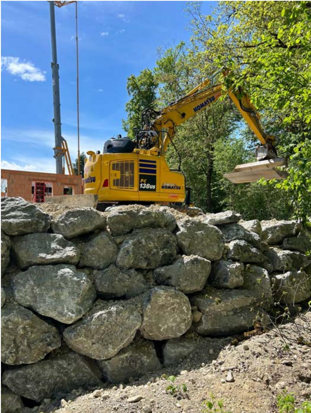
Bild 2: Der PC138US ist universell einsetzbar, sowohl für Aushubarbeiten auf kleineren Baustellen, als auch bei Kanal- und Abbrucharbeiten sowie bei der Feinplanie.
