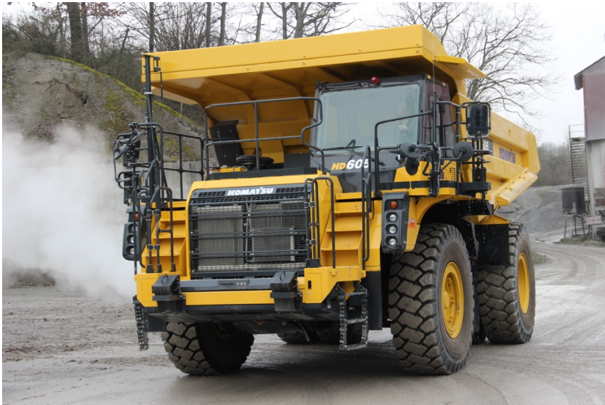
Bild 1: Im Muschelkalksteinwerk wird hochwertiger Rohstoff abgebaut, den Transport übernimmt der Komatsu HD605-8.
